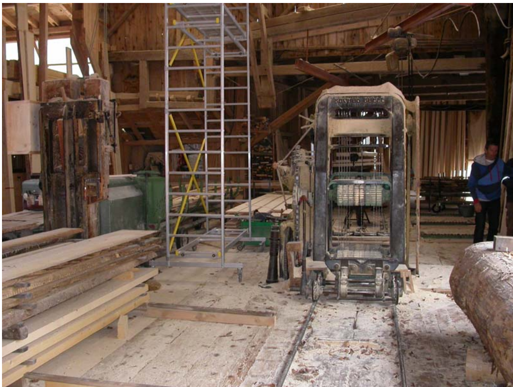
La multiple, cœur de la scierie. « Une pièce importante viendrait à lâcher, nous dit Jean-Victor Bonny, mon entreprise de sciage est foutue ! »
